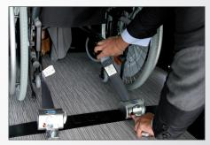
Il sollevatore Fiorella con F-Twister agevola l'accesso posteriore al veicolo per ancorare la carrozzina da posizione comoda e sicura.
